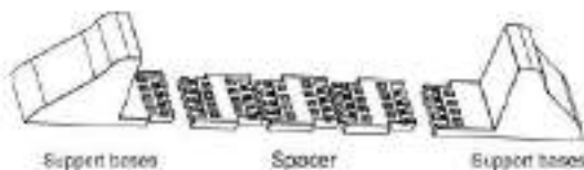
Fig.4-2 Instalación de bases de apoyo con los espaciadores
